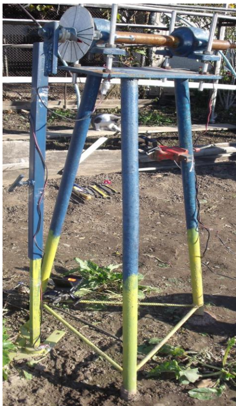
Рисунок 3.4 – Загальний вигляд лабораторно-польової установки маятникового копра
