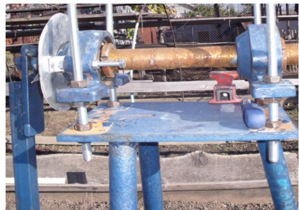
Рисунок 3.3 – Схема маятникового копра: 1 – рама установки; 2 – плита; 3 – пристрій регулювання; 4 – підшипник з корпусом; 5 – вісь; 6 – маятник; 7 – подовжувач; 8 – фіксатор; 9 – шкала; 10 – показник шкали; 11 – корпус з підшипником; 12 – плоский ніж; 13 – пружина ножа
